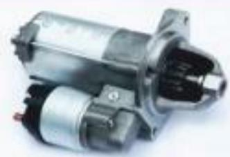
**Шестерня привода / Drive pinion**
